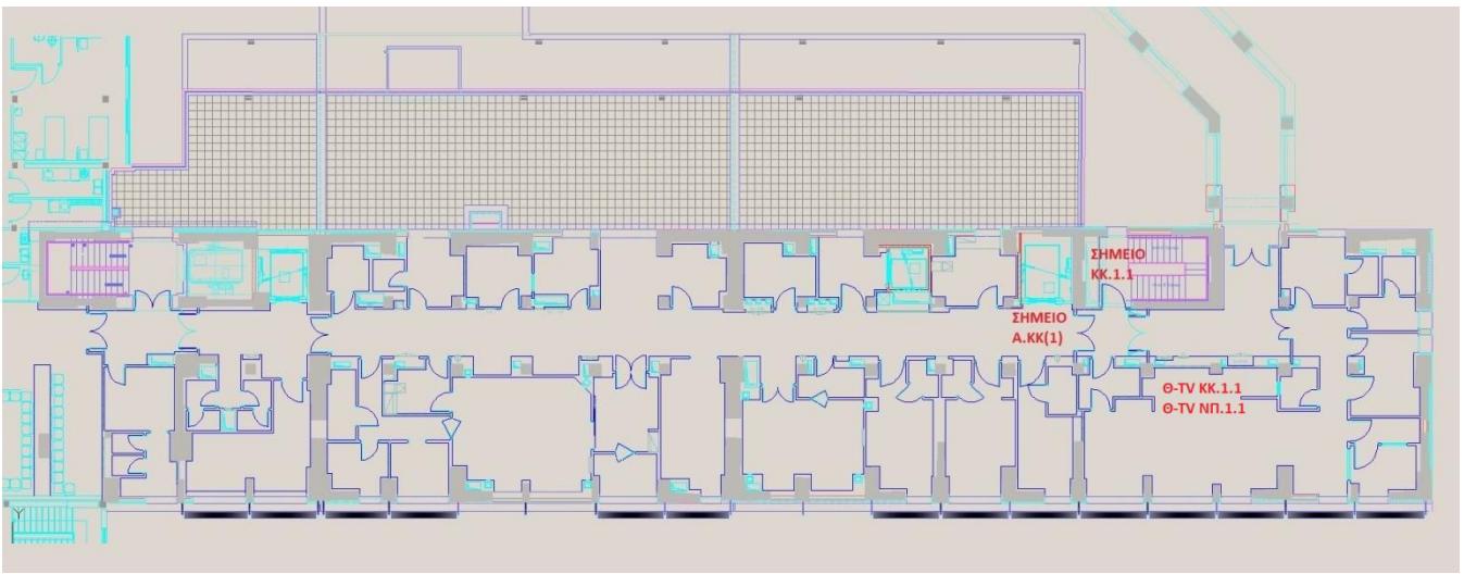
Σχήμα 7. Νέα σημεία ελέγχου πρόσβασης στον Α όροφο του πολυώροφου τμήματος του Κεντρικού Κτιρίου
