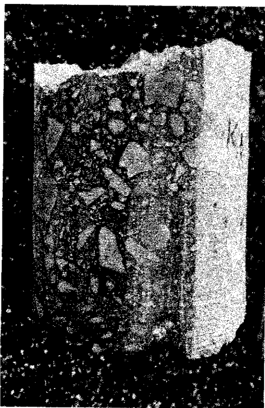
Σχήμα Π.1. Πυρήνας Π1 – Φάση Πυρηνοληψίας (Θέση: Πλάκα Π5)
